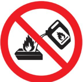
No rellene biocombustible si el dispositivo no está enfriado.
