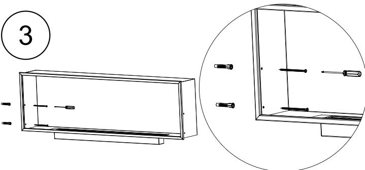
Se il caminetto a bioetanolo è già fissato a una nicchia, si utilizzano i fori di montaggio esistenti (non se ne praticano di nuovi). I supporti per i vetri e il fissaggio del caminetto a bioetanolo si effettuano contemporaneamente in un'unica fase. Fissare i portavetri utilizzando le viti e i tasselli forniti con il caminetto a bioetanolo.
