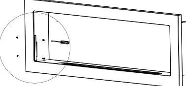
Los soportes de cristal deben fijarse con los tornillos y tuercas incluidos en el kit.
