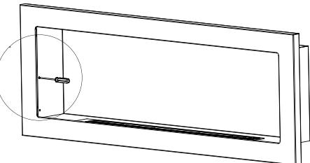
Les points de fixation les plus proches du cadre avant du foyer bioéthanol doivent être retirés à l'aide d'un tournevis ou d'un autre outil en appuyant dessus.
