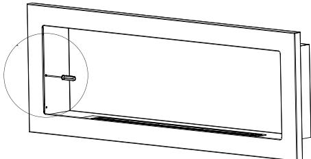
Los puntos de fijación más cercanos al marco frontal de la chimenea de bioetanol deben retirarse, por ejemplo, presionando con un destornillador u otra herramienta.
