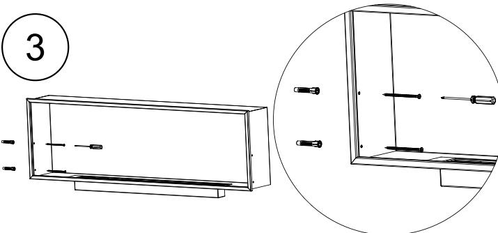
Si le foyer bioéthanol est déjà fixé à une niche, nous utilisons les trous de fixation existants (ne pas en percer de nouveaux). Les porte-verres et la fixation du foyer bioéthanol se font simultanément en une seule étape. Fixez les porte-verres à l'aide des vis et chevilles fournies avec le foyer bioéthanol.
