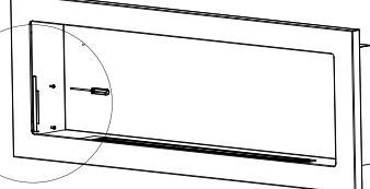
Les porte-verres doivent être fixés à l'aide des vis et des écrous inclus dans le kit.
