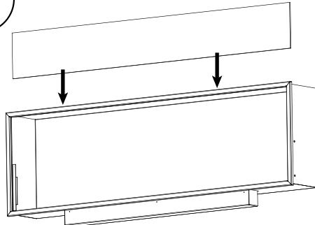
Deslice el vaso en los soportes de arriba abajo.
