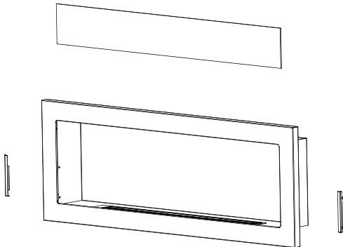
Die Montage muss erfolgen, bevor der Bioethanol-Kamin an die Wand gehängt wird.
