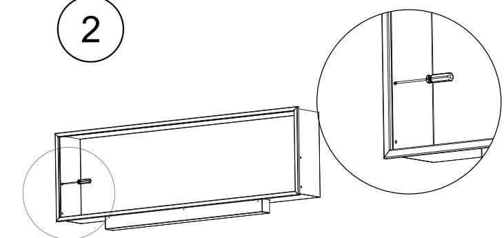
I punti di fissaggio più vicini al telaio anteriore del caminetto a bioetanolo devono essere rimossi con un cacciavite o un altro strumento, ad esempio premendo.
