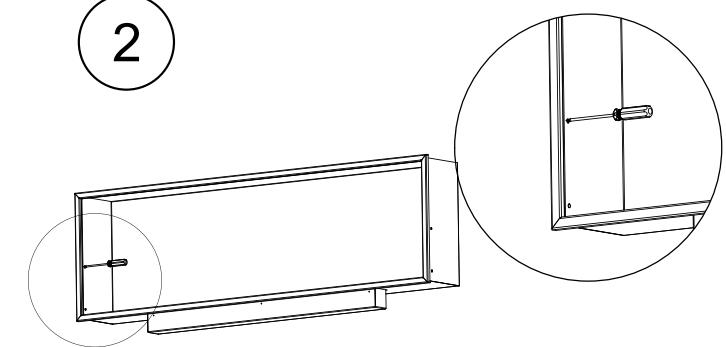
Les points de fixation les plus proches du cadre avant du foyer bioéthanol doivent être retirés à l'aide d'un tournevis ou d'un autre outil en appuyant dessus.
