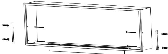
Die Installation muss gleichzeitig mit dem Einbau des Bioethanol-Kamins in die Wand erfolgen.
