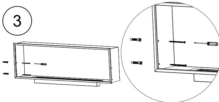
Wenn der Bioethanol-Kamin bereits an einer Nische befestigt ist, verwenden wir die vorhandenen Befestigungslöcher (keine neuen Löcher stanzen). Die Glashalterungen und die Befestigung des Bioethanol-Kamins erfolgen gleichzeitig in einem Schritt. Befestigen Sie die Glashalterungen mit den Schrauben und Dübeln, die mit dem Bioethanol-Kamin geliefert werden.
