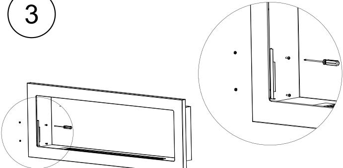
Die Glashalter werden mit den im Bausatz enthaltenen Schrauben und Muttern befestigt.
