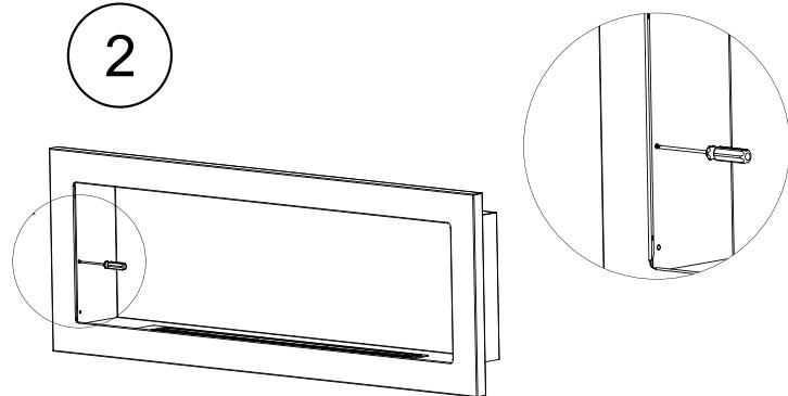
I punti di fissaggio più vicini al telaio anteriore del caminetto a bioetanolo devono essere rimossi con un cacciavite o un altro strumento, ad esempio premendo.
