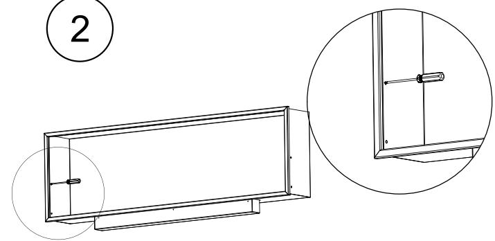
Die Befestigungspunkte, die sich näher am vorderen Rahmen des Bioethanol-Kamins befinden, sollten z. B. mit einem Schraubendreher oder einem anderen Werkzeug durch Eindrücken entfernt werden.
