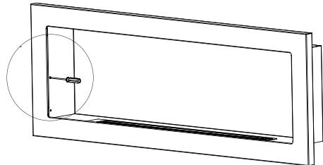
Die Befestigungspunkte, die sich näher am vorderen Rahmen des Bioethanol-Kamins befinden, sollten z. B. mit einem Schraubendreher oder einem anderen Werkzeug durch Eindrücken entfernt werden.
