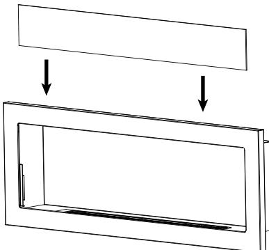
Deslice el vaso en los soportes de arriba abajo.
